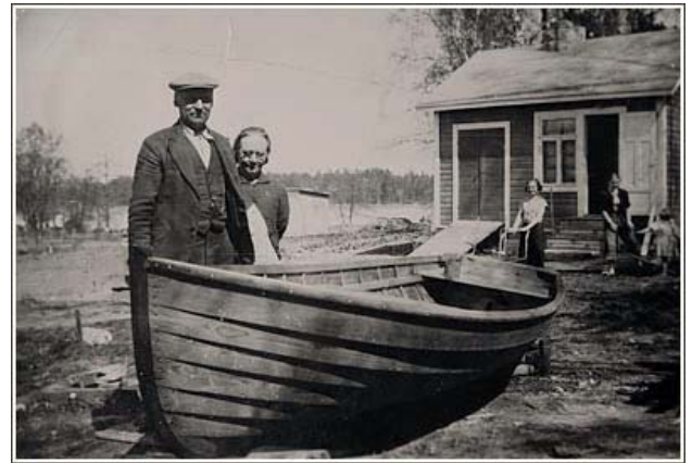
Ukki veisti itse tämän veneen. Se oli rungoltaan kalastajaveneen tyyppinen merivene ja siinä oli myös aikoinaan runkoon kiinnitetty moottori. Ukki oli joskus tehnyt siihen myös purjeet. Apulaitteita tarvittiin, sillä vene oli ilmeisesen raskas soutaa. Taustalla mökin edessä ovat Anna Oksa, Lahja Kuukkanen ja Säde Savolainen.
