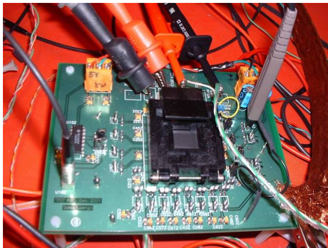
Figura 21. Fotografia d'una placa de test d'un circuit integrat que conté blocs individuals.
