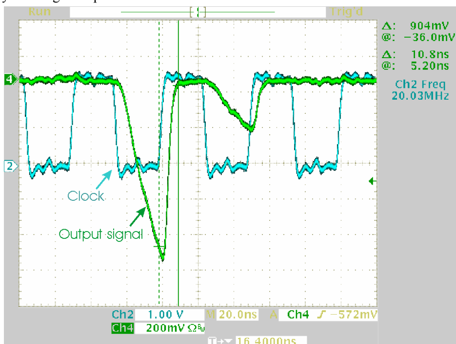
Figura 23. Sortida de l'integrador (verd) i rellotge de control dels interruptors (blau).
