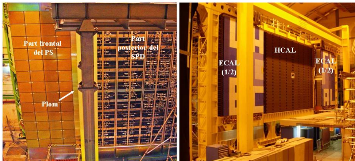
Figura 2. Imatges del sistema de calorimetria de LHCb. Esquerra: PS i SPD. Dreta: ECAL (obert) i HCAL abans de la instal·lació del PS i el SPD.
