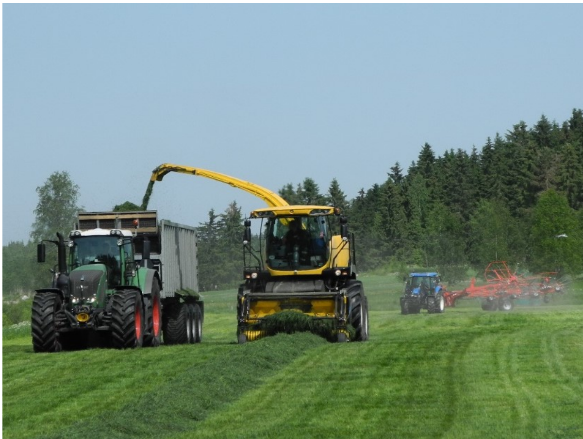
Kuva 19. Nurmisäilörehun korjuuta ajosilppurilla, taustalla karhotin. (Kuva: Marketta Rinne / Luke)
