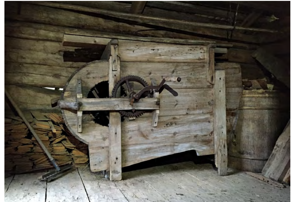
Akanakopissa on viskuri eli tuultokone, jolla puhdistetaan vilja pölystä, akanoista ja muista epäpuhtauksista. 2015.
