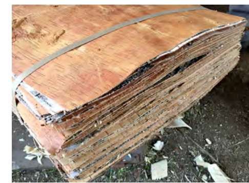
Tuohinipun levyjen käpristyneet reunat on sahattu pois, jotta tuohien käpristyminen valmiissa katteessa ei pääse alkuun. 2018.
