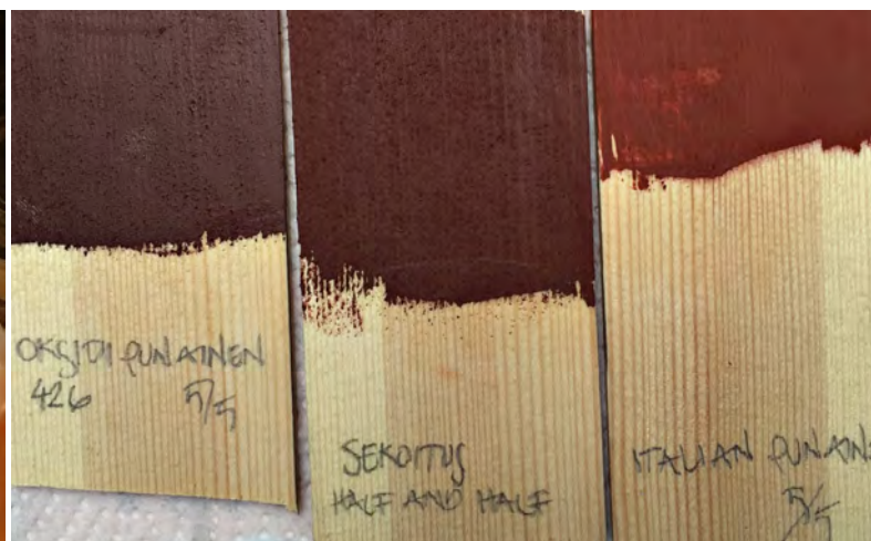
Kamarin kaakkoisivun ikkunan ulkopuitteiden kunnostusta syksyllä 2015; pellavaöljykyllästystä, värimalleja ja maalausta. Korjauksessa käytetyn maalin resepti on: 1 dl vernissaa ja 0,75 dl punamultaa (Rakennusapteekin italianpunainen).
