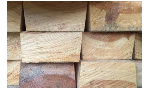
Kaivonkansien puutavara sahattiin siten, että soirojen väliset raot kasvavat alaspäin.
