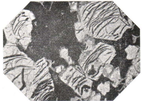
Fig. 6. Vergrößerter Ausschnitt aus dem Dünnschliff. Fig. 5. Schwarz: Magnetkies u. Magnetit. Hell: Olivinseudomorphosen (Talk u. Serpentin) mit Sprüngen, die von Magnetit erfüllt sind. Gew. Licht. Vergr. 35 ×.
