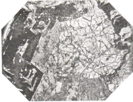
Fig. 3. Gabbrodiabas, N Seite von Kamikivittunturi. Das grosse, helle Korn ist mon. Pyroxen, die graue Masse umgewandelter Plagioklas. Rechts skelettartiges Titaneisenerz. Gew. Licht. Vergr. 10 ×.
