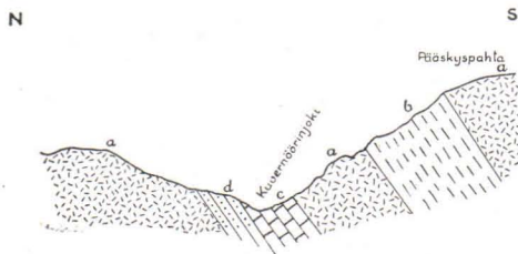
Fig. 5. Schematisches Profil durch die Gesteinsfolge am Unterlauf des Kuvernöörinjoki, am NE Ende des Kuotsjärvi. a = Grünsteine. b = Hälleflinta. c = Dolomit. d = Quarzit.
