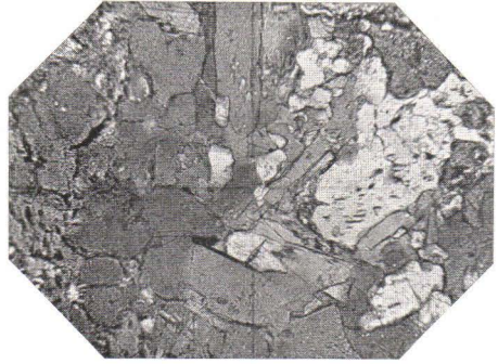
Fig. 2. Amphibolit, Kalguaivaie. Die dunklen Körner sind Hornblende, die hellen sind Epidot. Struktur granoblastisch. Gew. Licht. Vergr. 10 ×.
