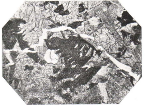
Fig. 4. Gabbrodiabas, N Seite von Kamikivittunturi. Hauptminerale: Plagioklas, mon. Pyroxen und Titaneisenerz. Gew. Licht. Vergr. 10 ×.
