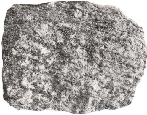
Fig. 1. Grauer Gneissgranit, Elvenes, Pasvik. Dunkle Streifen: Biotit. Ung. \frac{1}{2} der nat. Grösse. Samml. J. J. Sederholm.
