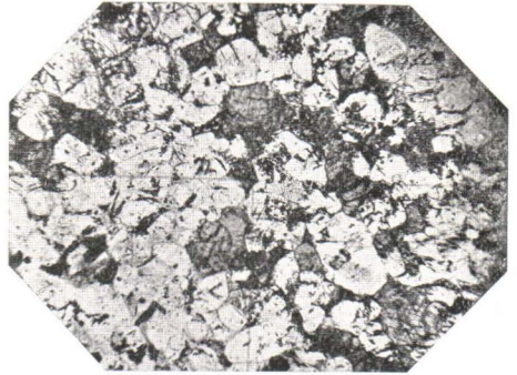
Fig. 2. Serpentinsteine, Ortoaive. Die hellen runden Körner sind Serpentin, die dunklen sind Überreste von Pyroxenen. Die schwarzen Flecken sind Eisenerz. Gew. Licht. Vergr. 10 ×.
