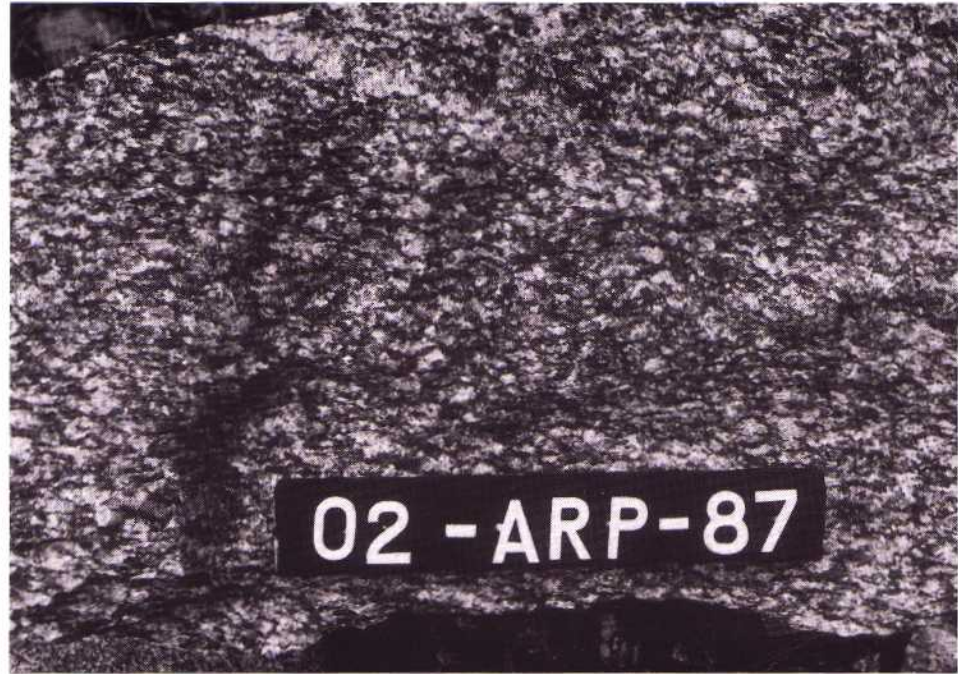
Kuva 17. Granodioriitti. Laatan pituus 12 cm. Fig. 17. Granodiorite. Length of the label is 12 cm. Kylmät mäet, 10B, x = 6989090, y = 3491770
