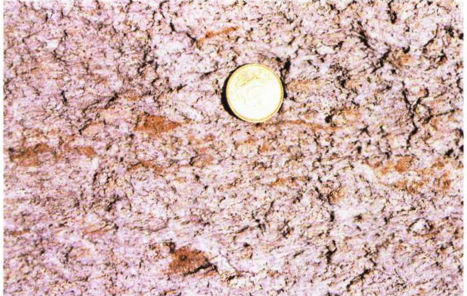
Kuva 14. Kvartsi-turmalinikivi. Kolikon halkaisija 25 mm. Fig. 14. Quartz-tourmaline rock. Diameter of coin 25 mm. Korttimomäki, 06C, x = 7062.260, y = 3557.440.
