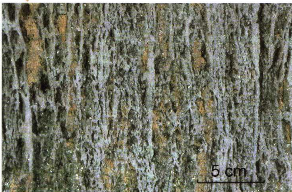
Kuva 13. Kvartsirikas kloriitti-kordieriitti-ortoamfibolikivi. Fig. 13. Quartzose chlorite-cordierite-orthoamphibole rock. Lumimäki, 06C, x = 7060.140, y = 3555.320.
