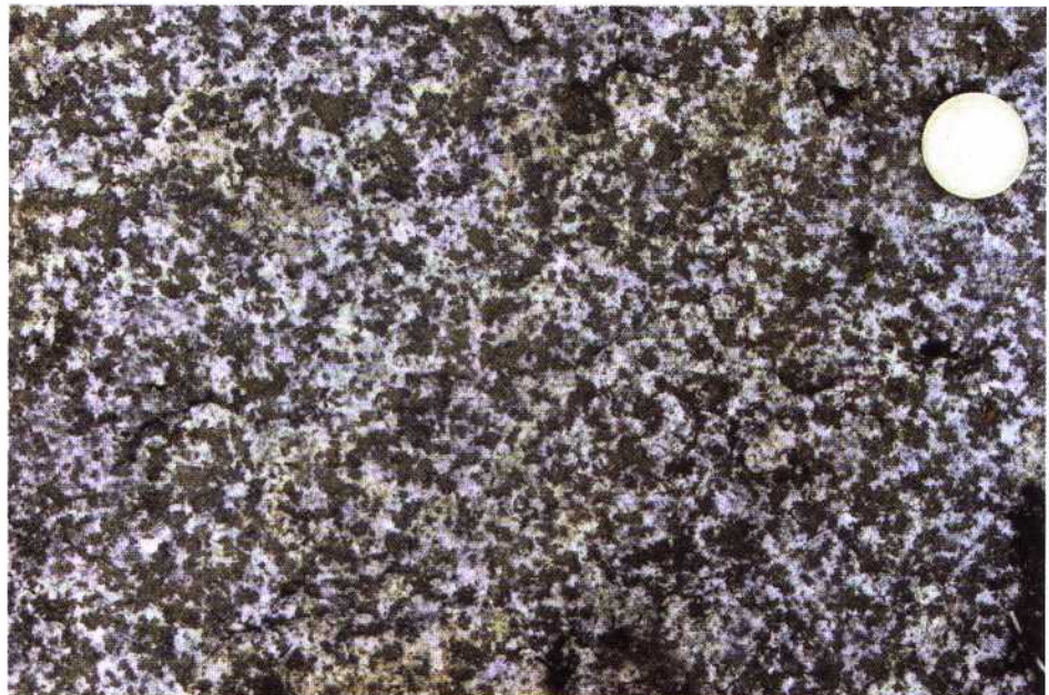
Kuva 21. Karkearakeinen, gabromainen diabaasimuunnos. Kolikon halkaisija 23 mm. Fig. 21. Coarse-grained, gabbroic type of diabase. Diameter of coin 23 mm. Tulisaari, 01B, x = 7045.560, y = 3543.870.
