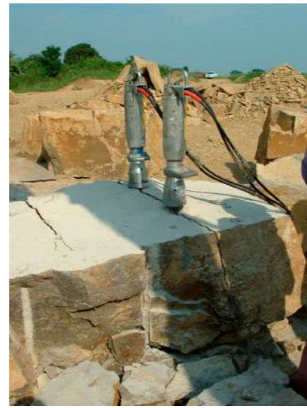
Figure 16 : Éclateurs hydrauliques en série (source : site Internet Svec)
