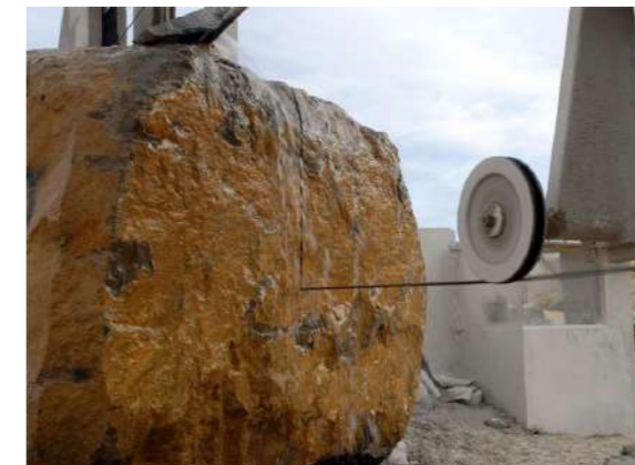
Figure 17 : Coupe d'une roche au fil diamanté (source : MDO - MRT)
